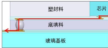
图 5 射频信号通过封装体的传输路径
